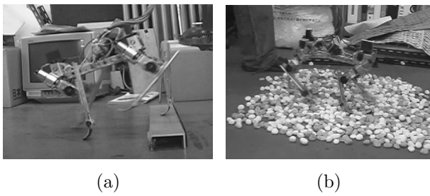
Fig. 3: 鉄犬 1 の (a)4cm 段差と (b) 小石路面での歩行写真．移動速度は 0.5~0.6[m/s] ．
