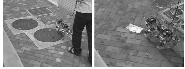
Fig. 5: 屋外 (大学構内) 歩行写真．移動速度は 0.5~0.6[m/s] ．
